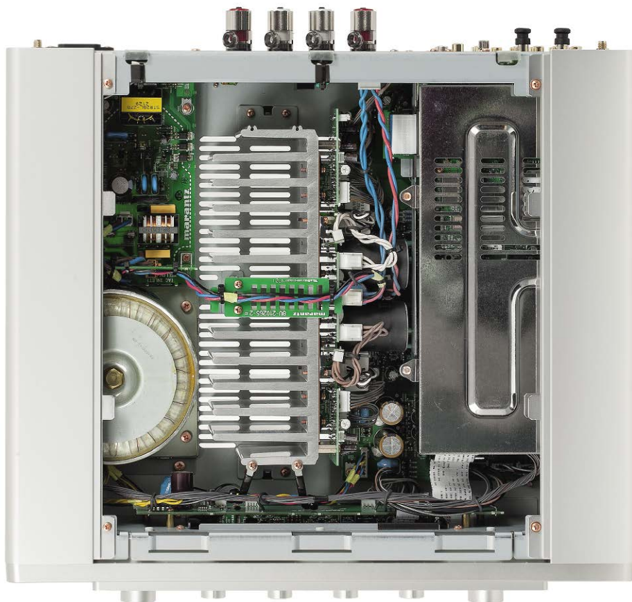
W Modelu 30 pracują układy impulsowe, w Modelu 40n – klasyczne końcówki liniowe.
